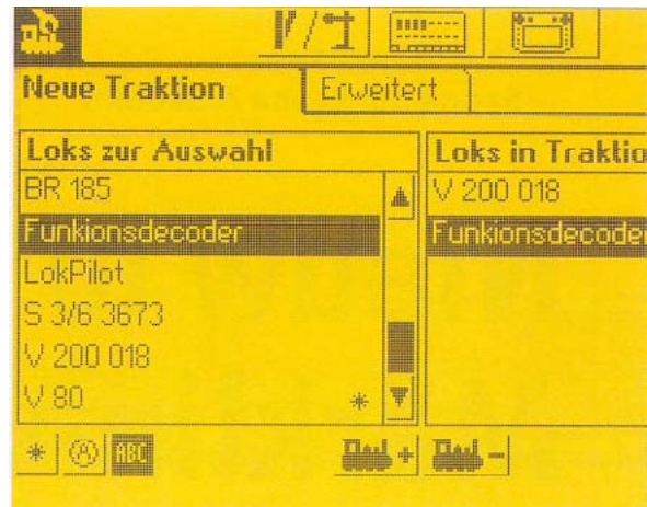
In de dubbele tractie kunnen loc- en functiedecoder samen worden geschakeld.
