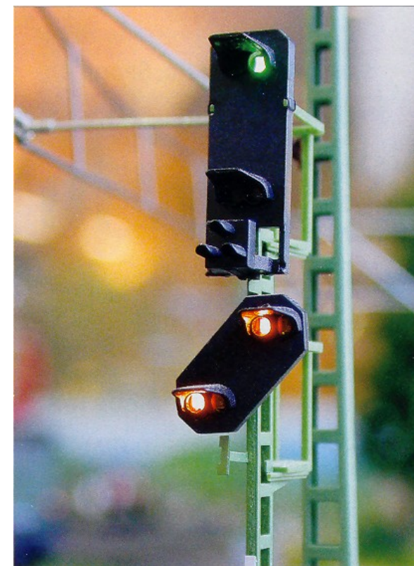
Bij het hoofdsein met voorsein wordt eerst het hoofd- en dan het voorsein geprogrammeerd.
