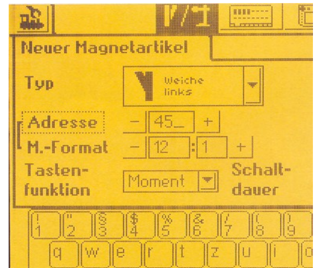
Het adres kan bij het Central Station vrij worden gekozen van 1 tot 256.
