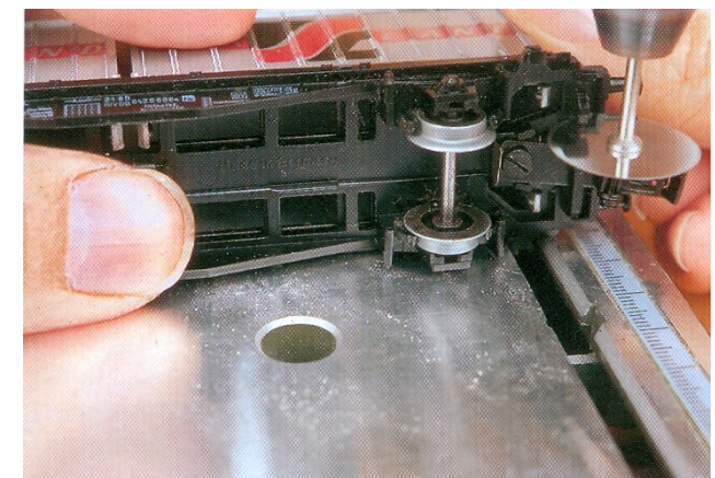
Met een in een boorstandaard bevestigde miniboormachine kan men de geleider gemakkelijk verwijderen.
