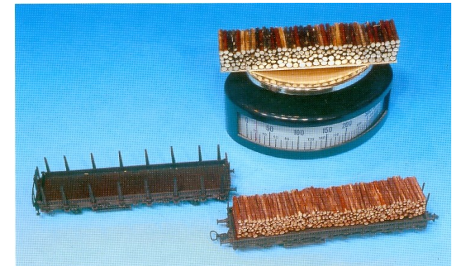
Bij wisselladingen blijft de gehele wagenbodem, inclusief de lading, uitneembaar. Wel goed het gewicht van de lading in de gaten houden.
