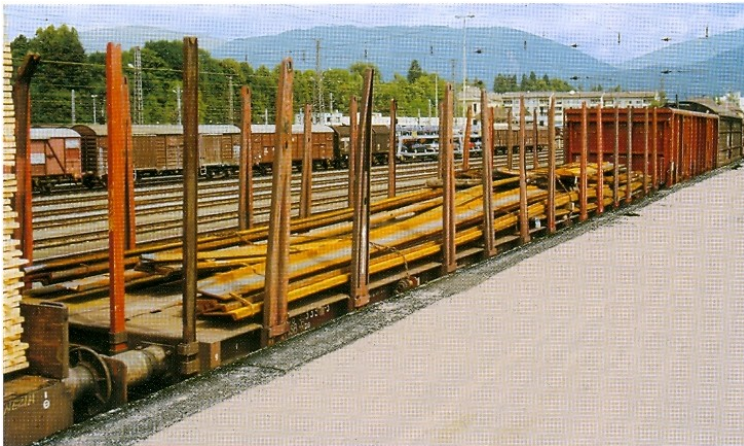
Bescherming van de lading kan ook door de wagen zelf gebeuren. Rongen en wanden moeten de lading aan de zijkant afdekken.
