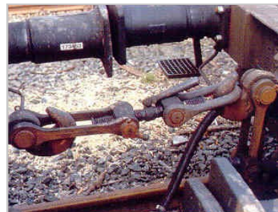
Twee met elkaar verbonden goederenwagens. De beugel van de rechter wagen wordt niet gebruikt. Deze is onder de trekhaak opgehangen.
