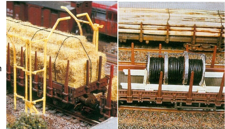
Er moet op worden gelet dat de lading binnen het vrije ruimte profiel blijft.
