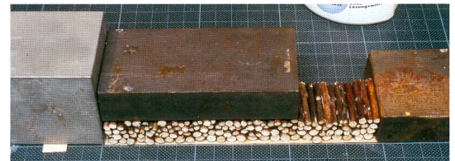
Tijdens het lijmen van de houtlaag met houtlijm moet men iedere laag verzwaren en goed laten drogen voor men aan de volgende laag begint..
