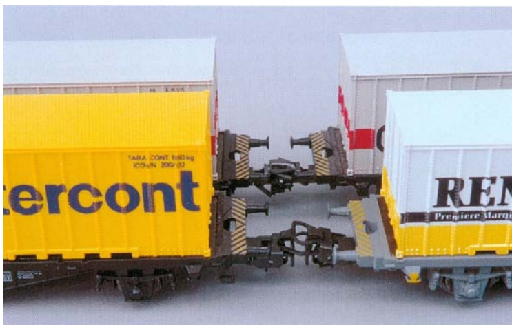
Bij wagens van dit type is de door de kortkoppeling verminderde koppelafstand bijzonder effectief.
