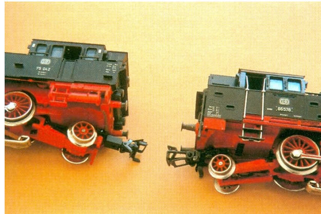
De ombouw naar kortkoppelingen gaat bij tenderlocs bijzonder snel en eenvoudig. De 75 (links) is al klaar (voor de bevestiging werd de aanwezige schroefdraad gebruikt). De 86 moet nog worden omgebouwd.
