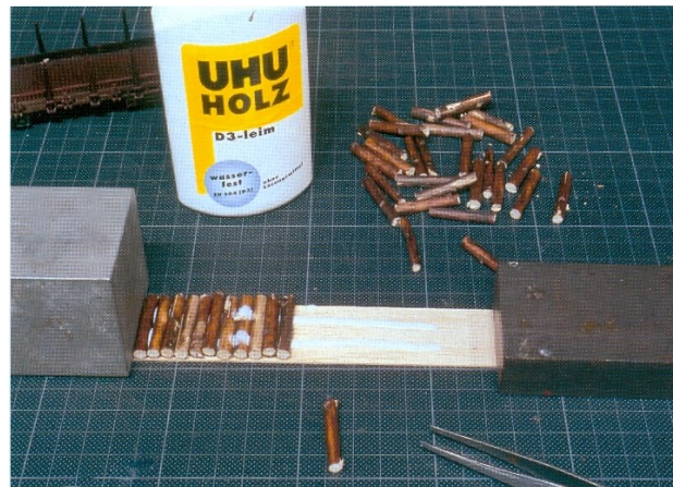
Als basis wordt een iets langer en op wagenbreedte gesneden stukje balsahout gebruikt. De op de kopkanten geplaatste gewichten voorkomen verschuiven en zijn tegelijk de aanslag voor de boomstammen.
