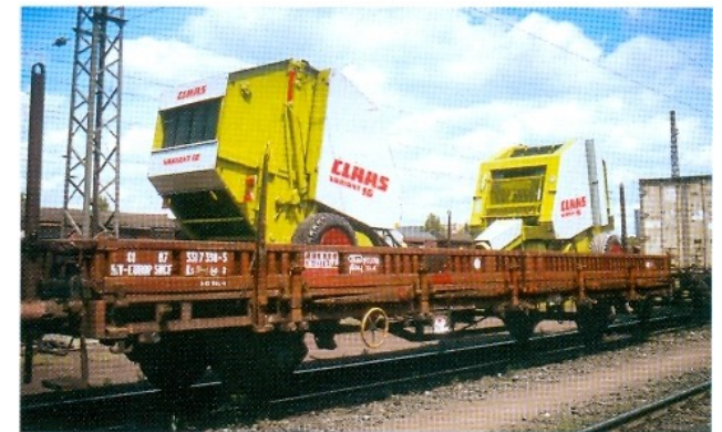
Tot de typische losse laadeenheden behoren grote goederen zoals machines, voertuigen, kisten, betonnen pre-fabdelen, enz. Deze moeten apart worden beveiligd.
