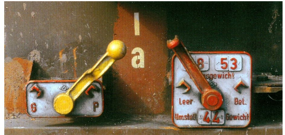
Hendels voor het soort remsysteem en het gewicht van de wagen: vanaf 44 ton wordt de rechter hendel naar rechts omgelegd.
