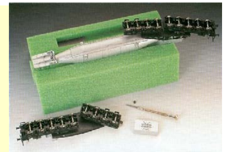
De grote draaistellen worden van de ketel verwijderd.
