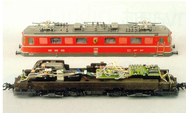
Typierend voor Zwitserse locomotieven is de gescheiden aansturing van het rechter achterlicht.
