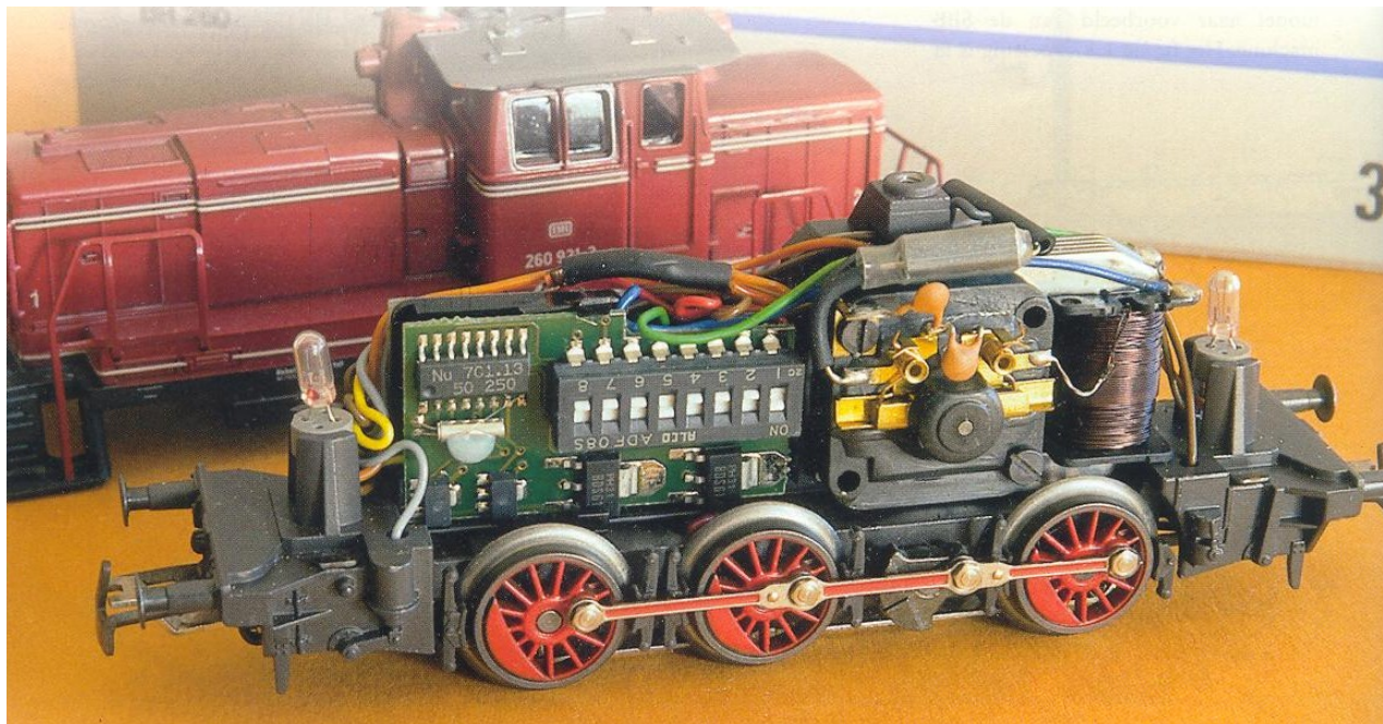
Bij de 3664 was als extra functie een telexkoppeling te schakelen. Op de decoder is de miniaturisering duidelijk te zien.
