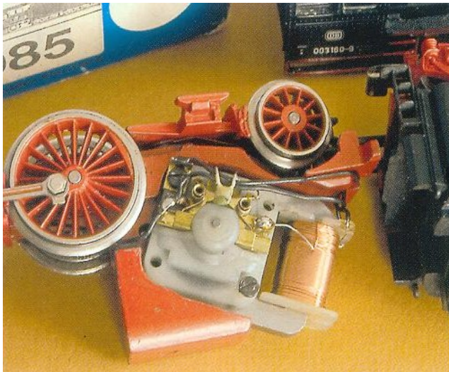
De serie 03 (art.nr. 3085) kreeg in 1973 al een trommelcollectormotor.
