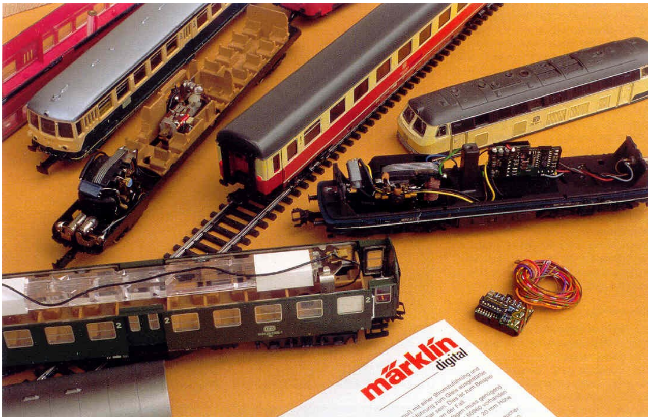
De functiedecoder c96 maakt het mogelijk talrijke speciale functies in rollend materieel te schakelen.
