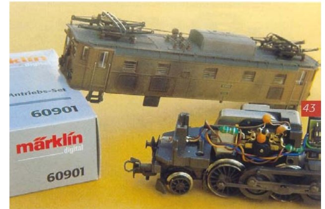
Vele modellen (van ongeveer 1974) hebben een trommelcollectormotor en zijn daarom geschikt voor de ombouw met een 60901.
