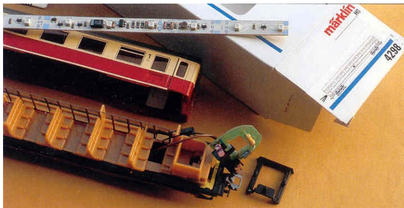
In dit rijtuig zullen we naast sluitverlichting een interieurverlichting inbouwen met de functiedecoder c96 apart te schakelen.
