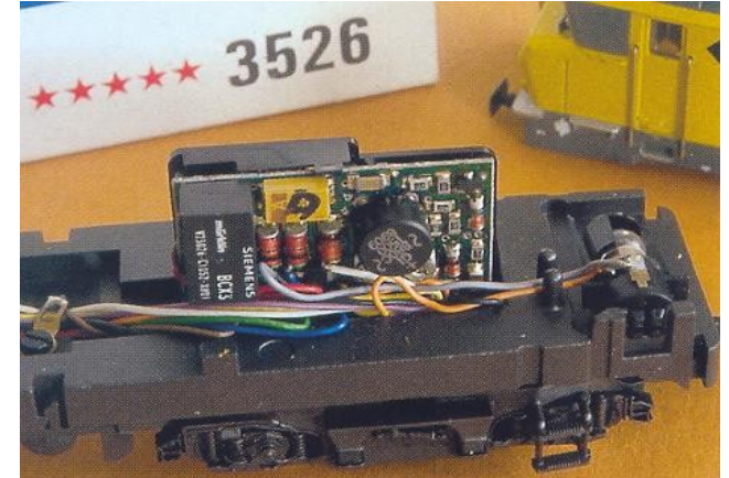
Voor de opwaardering van geregelde 5 sterren aandrijvingen werd aanvankelijk een ombouwset aangeboden. Het bevatte de nodige motoronderdelen en de electronica.
