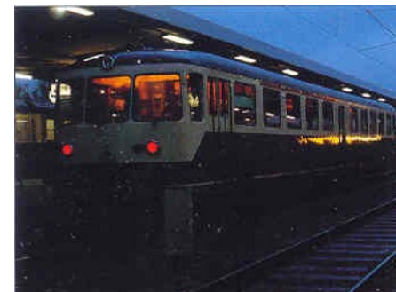
Als sluitverlichting werden bij dit treinset gekleurde schijven over de koplampen bevestigd. Ook hier is er gloeilampverlichting.
