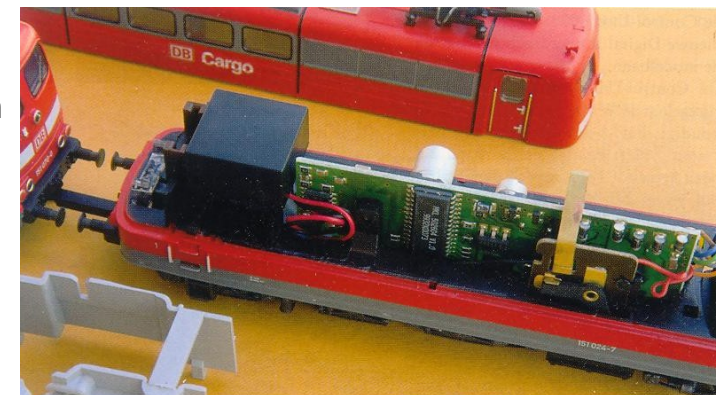
Bij deze multitractie werden geluidsmodule en de decoder op een gemeenschappelijke print ondergebracht.
