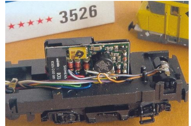
Voor de opwaardering van geregelde 5 sterren aandrijvingen werd aanvankelijk een ombouwset aangeboden. Het bevatte de nodige motoronderdelen en de elektronica.
