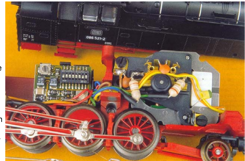
Deze loc uit de set 26508 werd als eerste in serieproductie voorzien van de motoronderdelen uit de 60904. De decoder is een speciale uitvoering zonder f1 en f2.
