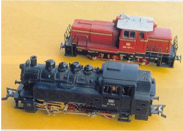
Naast iets grotere voertuigen uit de serie 85 en 86 zijn ook deze 2 modellen voorzien van Telex-koppeling. Voor een relais is in beide locs echter geen plaats.
