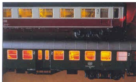
Deze rijtuigen verduidelijken het kleurverschil tussen verlichting met gloeilampen en (gele) LED's.
