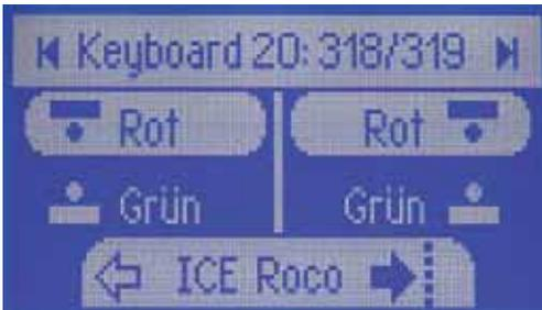
Beim Solo-Betrieb der Mobile Station II werden im Keyboard-Modus lediglich die Symbole „Rot“ und „Grün“ angezeigt, analog zum weit verbreiteten ...
