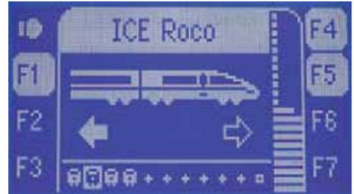
Dieser Roco-ICE mit DCC-Decoder wurde von der Central Station übernommen und wird mit den dort abgespeicherten Funktionen angezeigt
