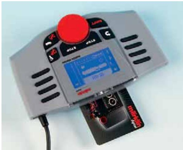
Die interne Lokliste der neuen Mobile Station II umfasst bis zu zehn Triebfahrzeuge. Ein elftes Fahrzeug lässt sich mit einer Lokkarte aktivieren, die sich in den Schlitz an der Rückseite unterhalb des Displays einstecken lässt
