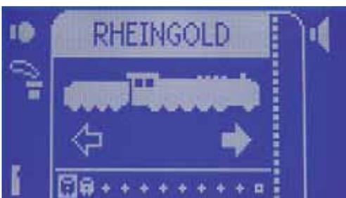
Die Rheingold-Lok ist ein Beispiel für ein Fahrzeug aus der Datenbank. Neben Name und Loksymbol werden auch die verfügbaren Funktionen angezeigt
