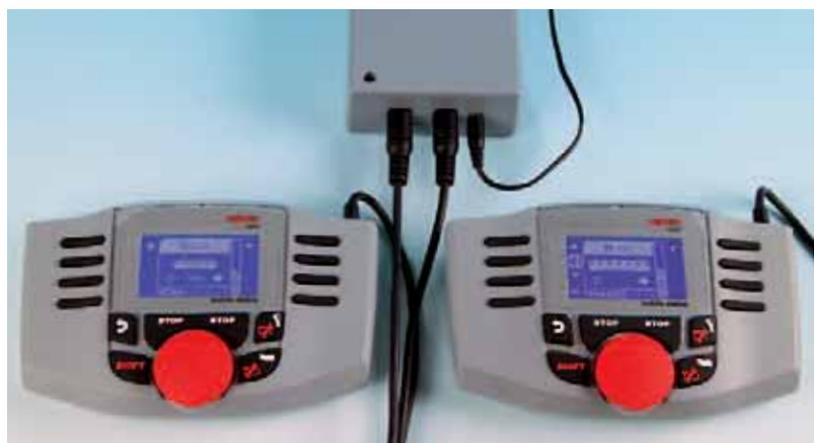
Zwei Mobile Stations II, angeschlossen an einer Gleisbox. So hat man bis zu 20 Loks im direkten Zugriff, zwei weitere können über Lokkarten angesprochen werden
