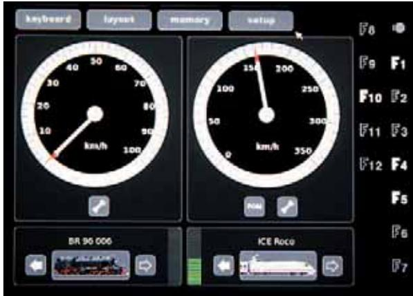
Der Bildschirm (Ausschnitt) der Central Station II. Wird ein hier angezeigtes Fahrzeug von einer angeschlossenen Mobile Station II gesteuert, werden eingestellte bzw. sich verändernde Werte (Fahrtrichtung, Tacho und Geschwindigkeitsbalken) synchron angezeigt
