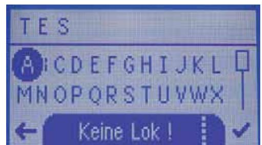
Im nächsten Schritt kann ein bis zu 16-stelliger Klartext-Name eingegeben werden. Die Buchstaben-Auswahl erfolgt mit Shift-Taste und Drehregler
