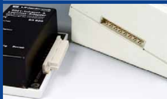
Auf der rechten Seite kann der Uhlenbrock-Adapter direkt an den I2C-Bus der Märklinschen 6021 angesteckt werden.
