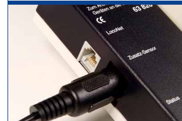
Der zweite Anschluss ist für sechspolige Westernstecker geeignet und erschließt dem Adapter und somit der 6021 die Welten des LocoNets.
