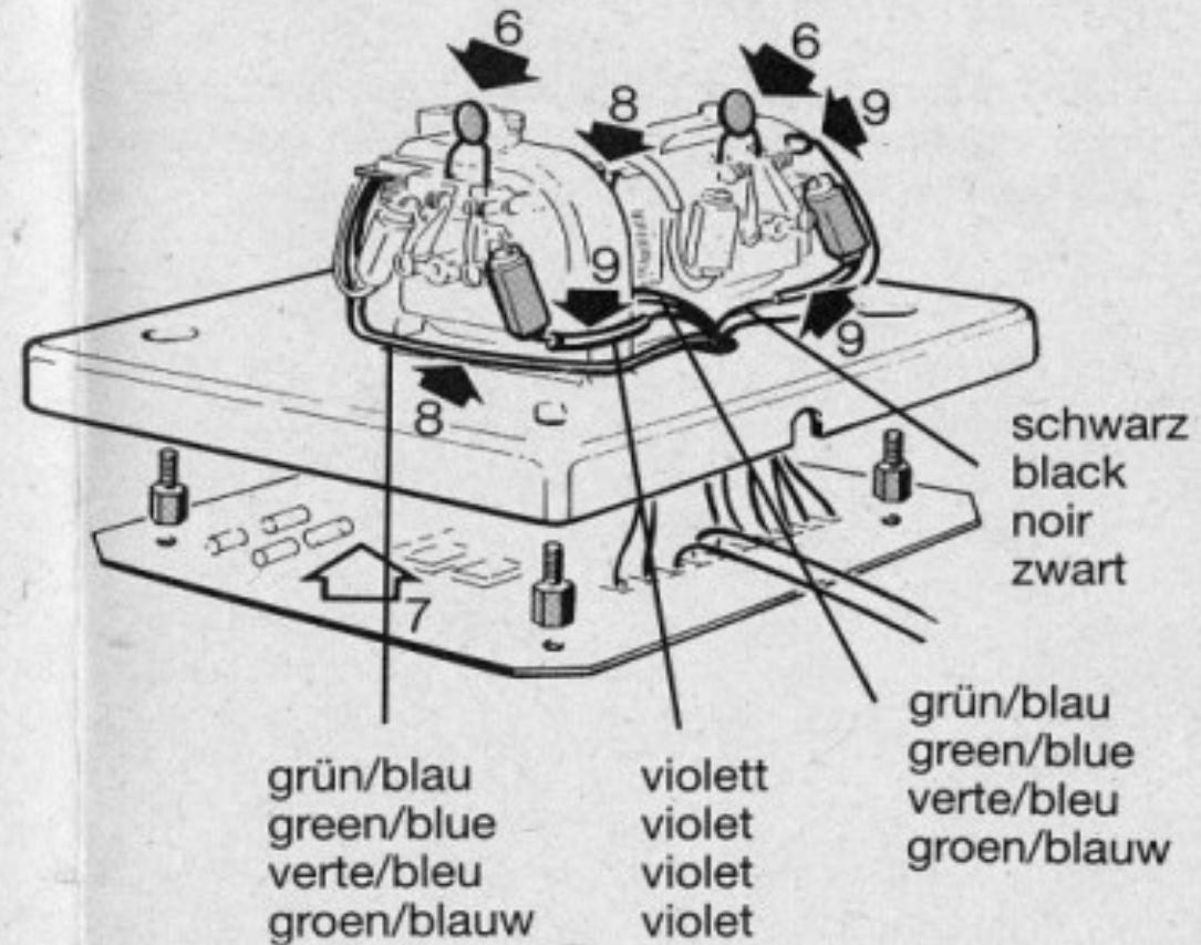
Graues Kabel am Aufbau anlöten. Druckfeder und Unterlegscheibe einsetzen und Grundplatte anschrauben (10).
