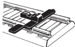
**Spezialkupplung in Kupplungshilfe einschieben.**
