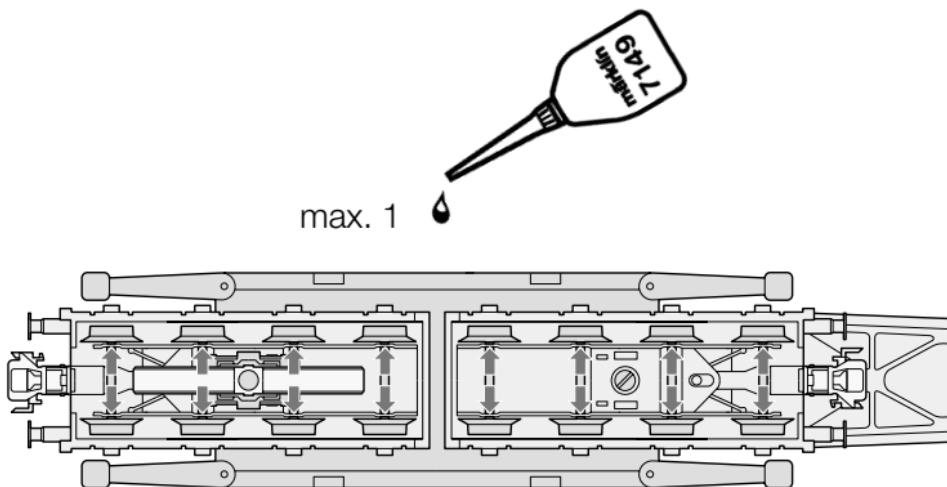
Schmierung der Zahnräder (bei Bedarf)
